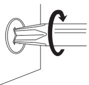
ボルト類のゆるみと部材の接続部は定期的に点検し、ゆるみなどがあつた場合はしっかり締め直してください。ゆるんだまま使用した場合、変形・破損及び転倒の危険があります。
