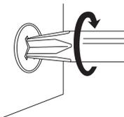
ボルト類のゆるみと部材の接続部は定期的に点検し、ゆるみなどがあった場合はしっかり締め直してください。ゆるんだまま使用した場合、変形・破損及び転倒の危険があります。
